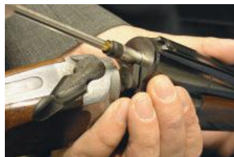
Auch für Kipplaufwaffen gibt es ein Waffenschloss. Es wird ins Patronenlager eingeführt.
